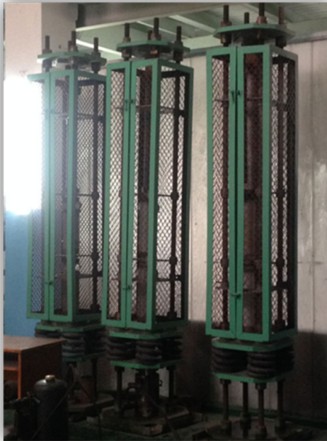
Рис. 1. Стенди для дослідження повзучості й тривалої міцності
